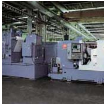
글리슨 베벨 기어 연삭기 피닉스 #400PG Gleason PHOENIX Bevel Gear Grinder #400PG
